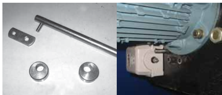
VARILLA DE DISPARO, TOPES REGULABLES Y VÍNCULO ENTRE VARILLA Y FIN DE CARRERA
